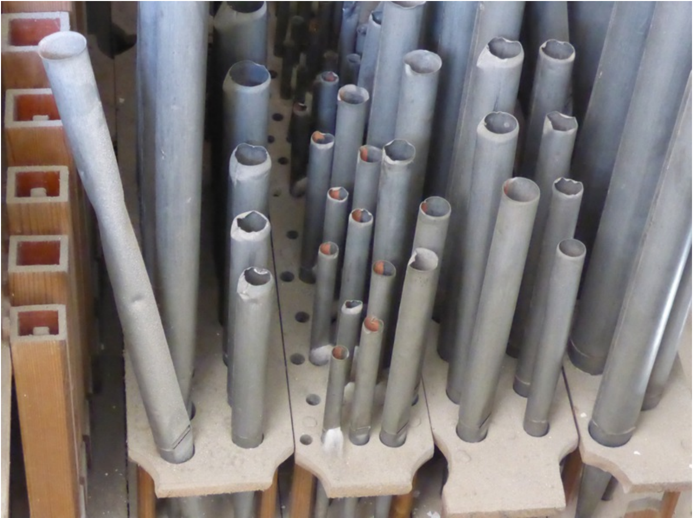
Mixtur: ein fehlender Chor und zwei abgesteckte Reihen. Also "klingt" momentan nur ein Chor
