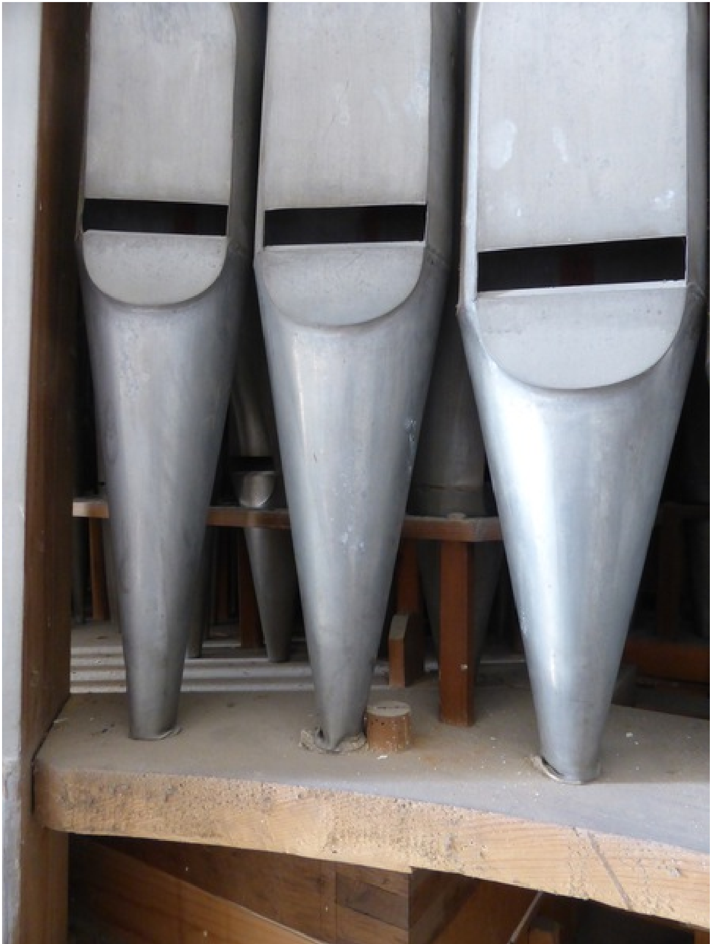
Eingesunkene Pfeifenfüsse der grössten Prospektpfeifen des Prinzipal 8' im Mittelfeld
