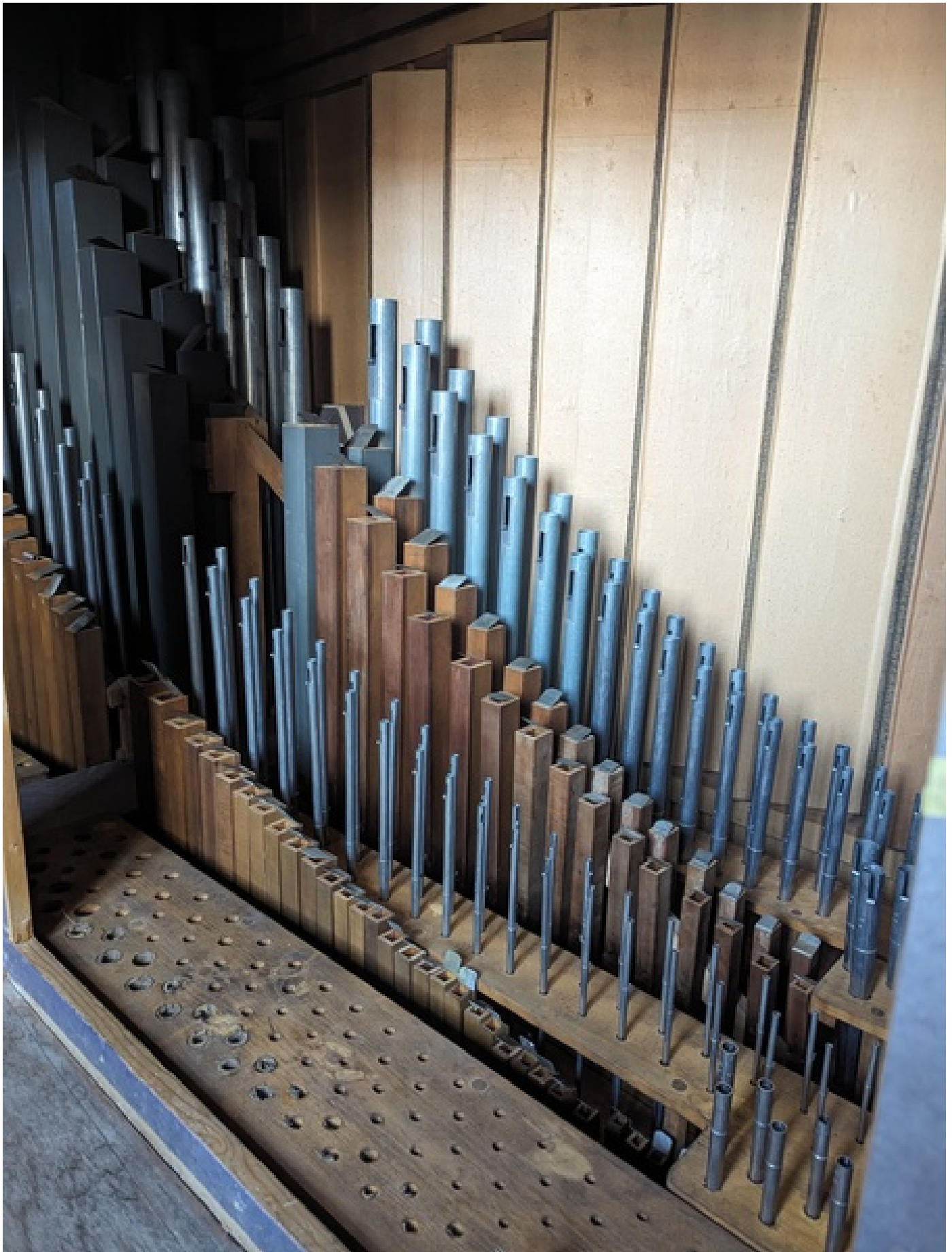
im Schwellwerk; Pfeifen mit unterschiedlicher Herkunft in der Mischung von Karl Einschenck
