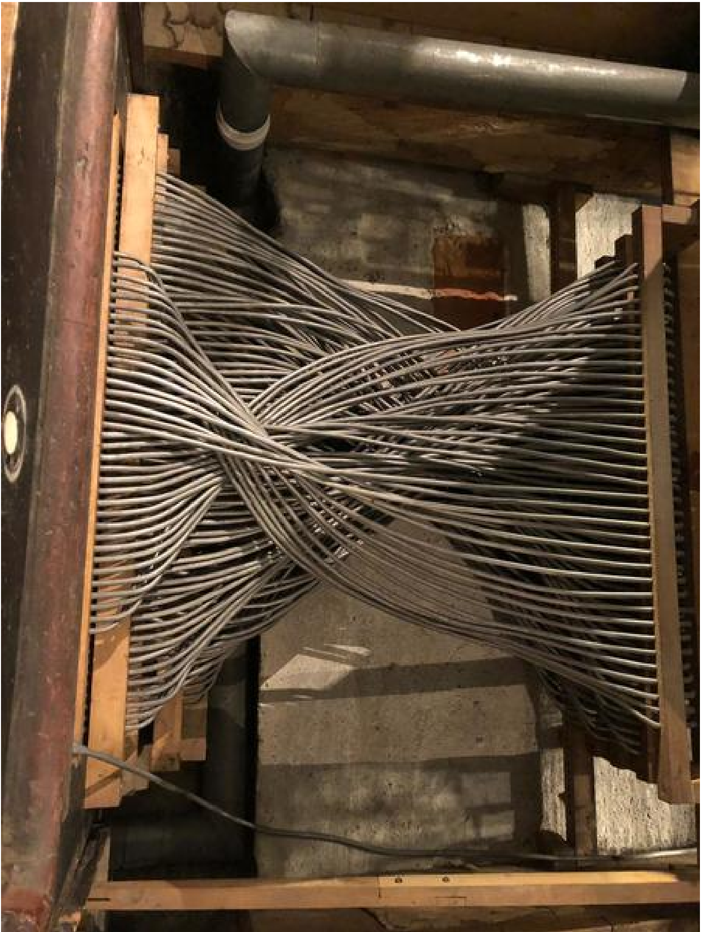
Pneumatische Traktur zwischen Spieltisch und Orgel
