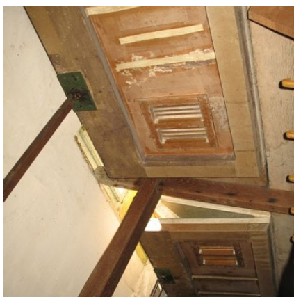
Schöpfungsbälge 1908-2013 unter dem Stimmgang, die den Magazinbalg (auf dem "Stimmgang") speisen
