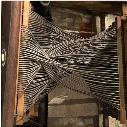
Pneumatische Traktur zwischen Spieltisch und Orgel
