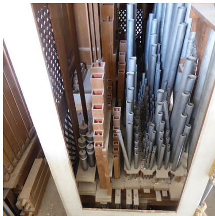
seitlicher Einblick in die Orgel: schwach sichtbar ichtbar die Aufdoppelung der Stöcke im Pedal links und im Manual rechts
