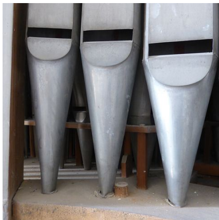
Eingesunkene Pfeifenfüsse der grössten Prospektpfeifen des Prinzipal 8' im Mittelfeld
