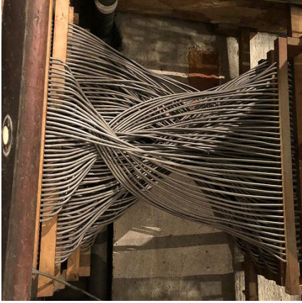
Pneumatische Traktur zwischen Spieltisch und Orgel
