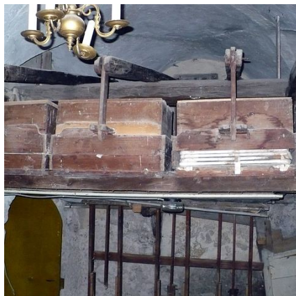
Balganlage in Sakristei
